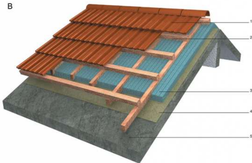
B. Θερμομόνωση στέγης από πλάκα σκυροδέματος με θερμομονωτικό υλικό απρόσβλητο από την υγρασία.
