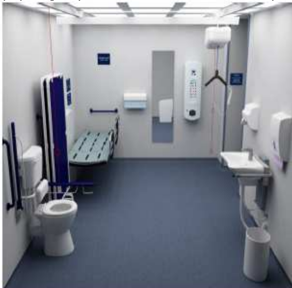
Εικόνα 23: CP και σύστημα κλήσης κινδύνου κόκκινα κορδόνια για να ξεχωρίζουν. Συνιστάται η τοποθέτησή τους στην είσοδο και δίπλα από λεκάνη WC ή ντους
