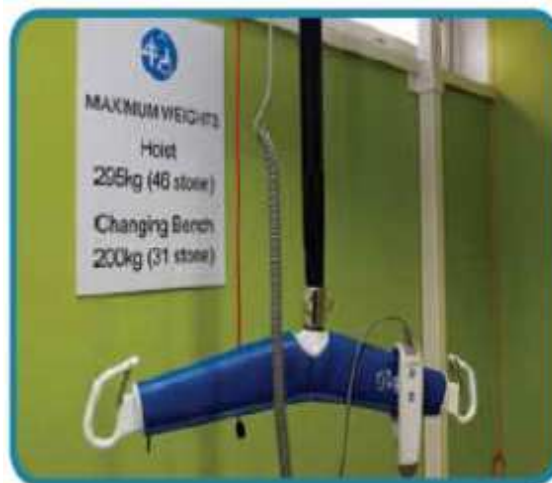
Εικόνα 14: Πινακίδα ενημερωτική για το μέγιστο φορτίο ανύψωσης και για τον τρόπο λειτουργίας του μηχανισμού
