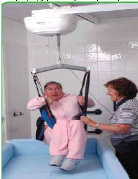
Εικόνα 2: Σύστημα ανάρτησης (hoist system) και φάκελος ανάρτησης (sling)
